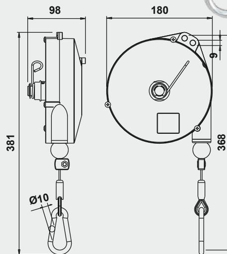
Ces équilibreurs sont équipés avec un dispositif qui bloque la course par moyen d'une simple manoeuvre sur la charge.
